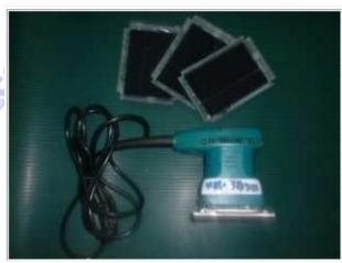
平面バリ取りを手のひらサイズ工具
